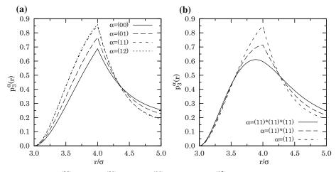
r/ $\sigma$  **Fig. 3** a Plot of  $p_3^{(00)}(r)$  (--),  $p_3^{(01)}(r)$  (--),  $p_3^{(11)}(r)$  (--), and  $p_3^{(12)}(r)$  (...) at  $T^* = 1$  and  $p^* = 1$ . **b** Plot of  $(p_1^{(11)} * p_1^{(11)} * p_1^{(11)})(r)$  (--),  $(p_1^{(11)} * p_2^{(11)})(r)$  (--), and  $p_3^{(11)}(r)$  (--) for the SW fluid ( $\lambda = 3$ ) at  $T^* = 1$  and  $p^* = 1$
